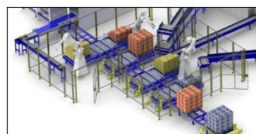
(1) Préparation de commande et palettisation automatisée à 100 % ; (2) Contrôle automatique de préparation de commande ; (3) Traçabilité et contrôle automatique du chargement.
