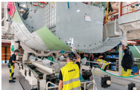
Les réservoirs de la récente déclinaison XLR de l'A321 en étendent le rayon d'action au-delà du court/moyen-courrier.
